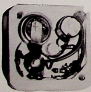
Het interieur met LDR, μA-meter en kwikcel.
